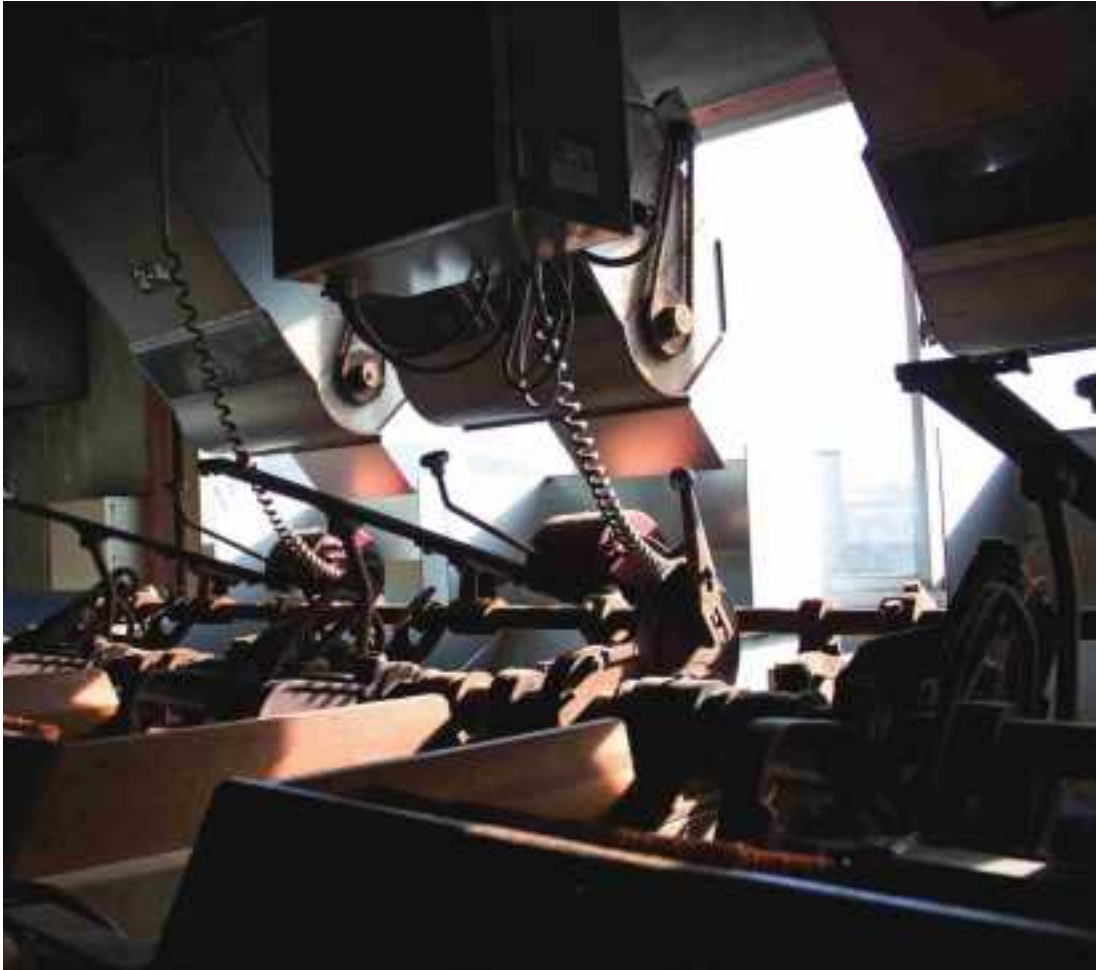
煎茶葉を針のように細長く整える精揉機 The machine for the final rolling
